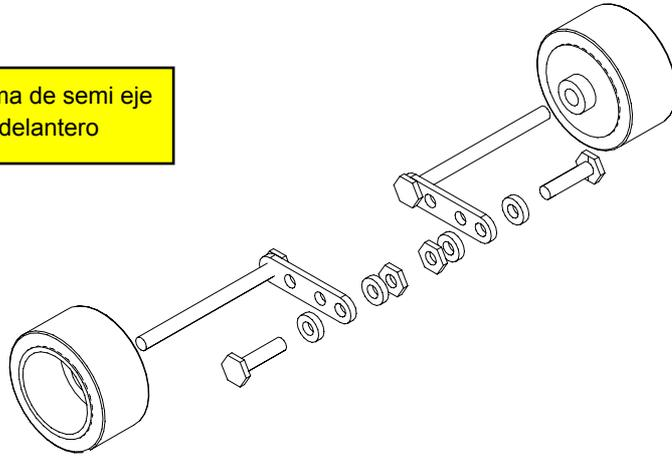
Vista del sistema de suspension delantera por eje rigido.
